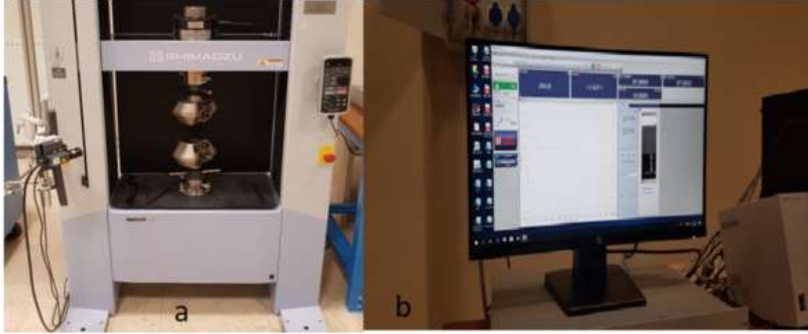
Görsel- 1 (a) SHIMADZU universal test cihazı, (b) Sonuçların alındığı bilgisayar
