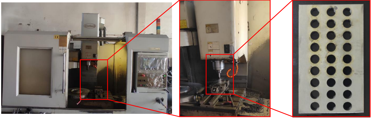
Görsel 1. Deneysel düzenek ve deney sonucu elde edilen delikler
