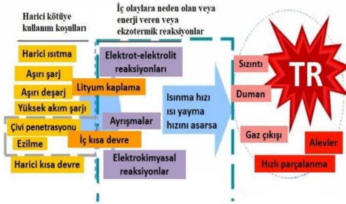
Görsel 3. Bataryada termal kaçağa sebep olan durumlar [7].
