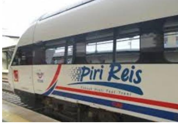
Şekil 5. TCDD YHT hatlarında test ve ölçüm yapan Piri Reis treni [9]
