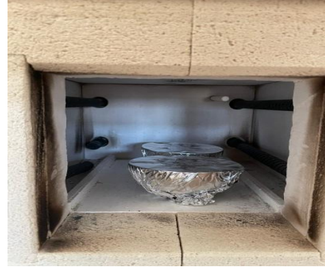
Görsel 2.2. Zeytin Yapraklarının Kül Fırında Yakma Öncesi Hazırlanması ve Kül Fırında Yavaş Piroliz İşlemi
