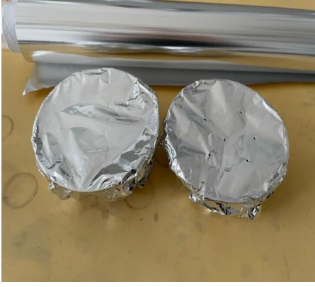
Görsel 2.2. Zeytin Yapraklarının Kül Fırında Yakma Öncesi Hazırlanması ve Kül Fırında Yavaş Piroliz İşlemi
