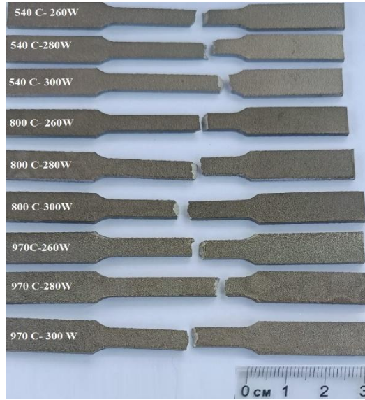
Görsel 6. Çekme test sonrası numunelerin görüntüsü
