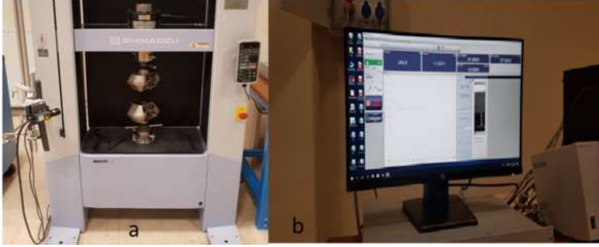
Görsel- 1 (a) SHIMADZU üniversal test cihazı, (b) Sonuçların alındığı bilgisayar
